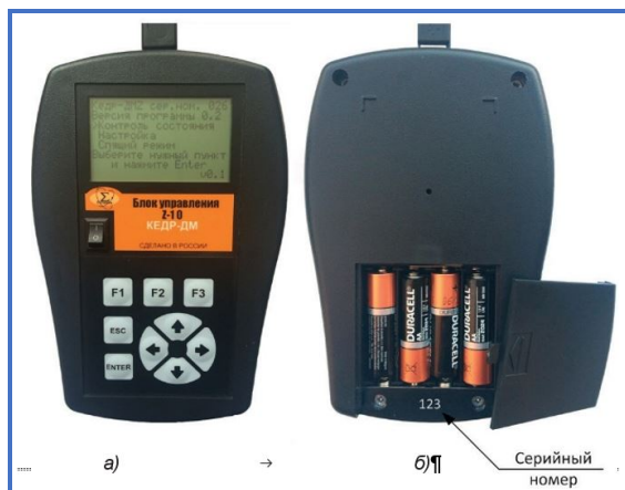
Рисунок 7 – Блок управления БУ Z-10: а) передняя панель, б) батарейный отсек
